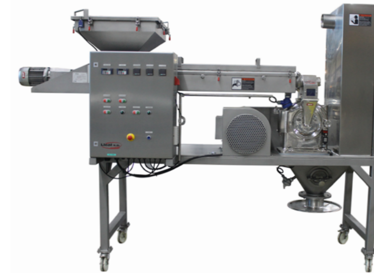
Instalación de molienda criogénica K-160 pharma , equipada con filtro de mangas automático
