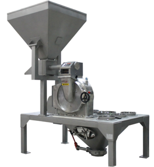
Instalación de molienda K-500-B, con alimentador de tornillo sinfín TK equipado de tolva especial de 600 L. Descarga mediante válvula de mariposa de accionamiento manual.
