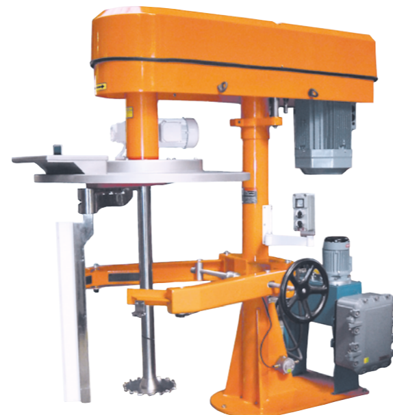
Dissolver coaxial de 18,5 kW con brazos y mordaza de sujeción. Tapa atmosférica
