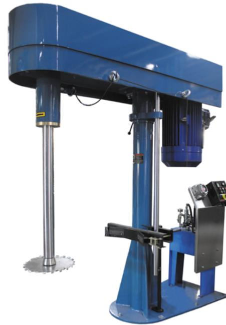
Dissolver S-1 con sujeción tipo correa
