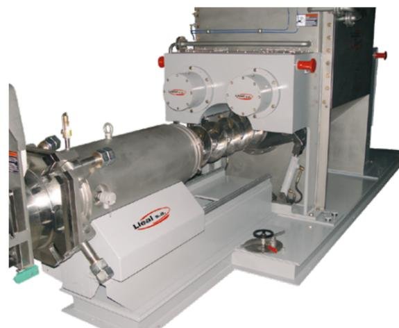
Vista del desmontaje de un tornillo extrusor para la limpieza
